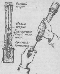
Рис. 111, Ручная граната М-24.
