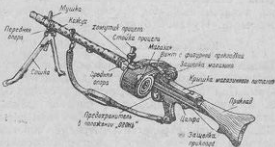
Рис. 93. Ручной пулемет МГ-34 с магазинным питанием.
