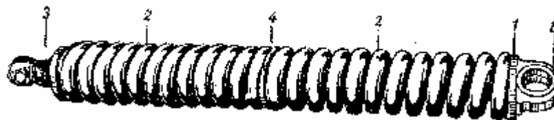
Рис. 140. Общий вид подвески 2, 3, 4 и 5-го опорных катков 1 — шток с проушиной; 2 — пружина; 3 — регулировочный стакан; 4 — направляющая втулка, 5 — втулка проушины
